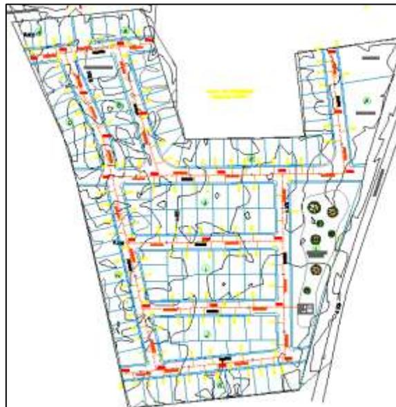
**Figura VIII-6:** Sistema General de la red de Alcantarillado del proyecto.
