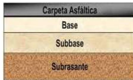
**Imagen IX-10:** Estructura de un pavimento flexible
