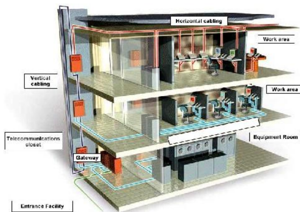
Figura 2.5 Subsistemas del Cableado Estructurado
