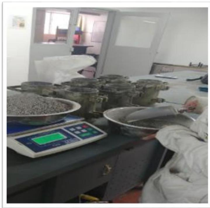
*Figuras 5 y 6. Elección del molde para probeta y pesado de materiales respectivamente*
