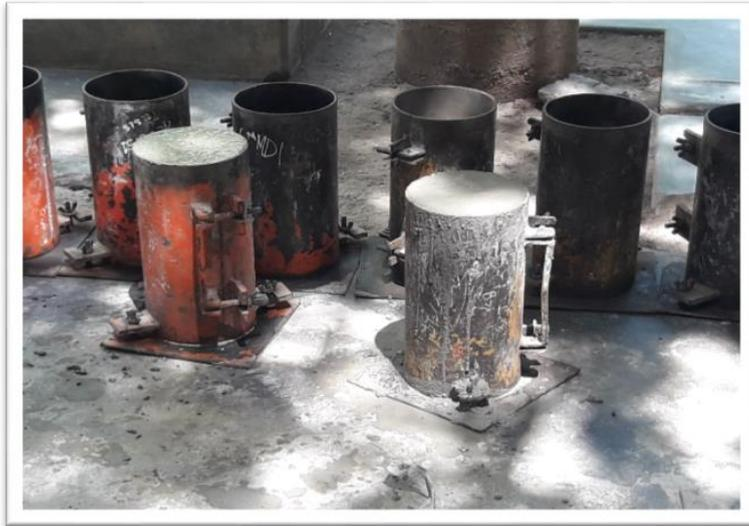
*Figura 11.* Llenado de la mezcla en los moldes de probetas
