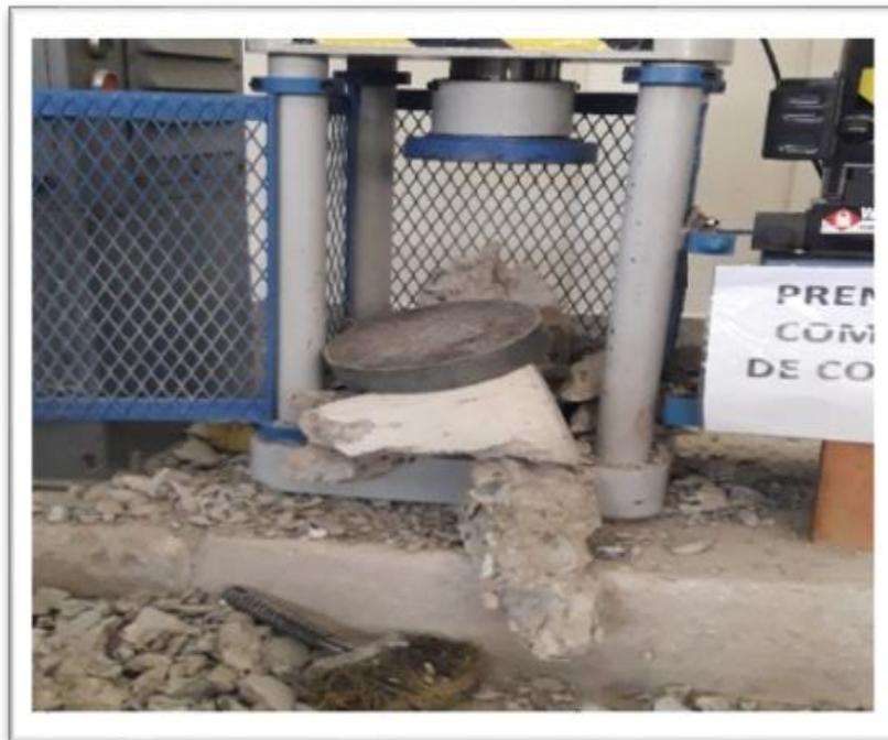
*Figura 17.* Destrucción de la probeta de 7 días después de su elaboración
