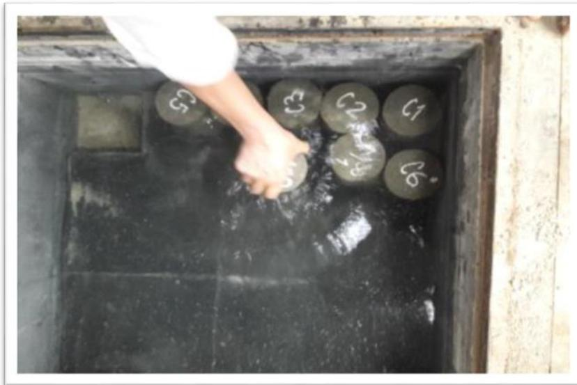
*Figura 13. Curado de las probetas*
