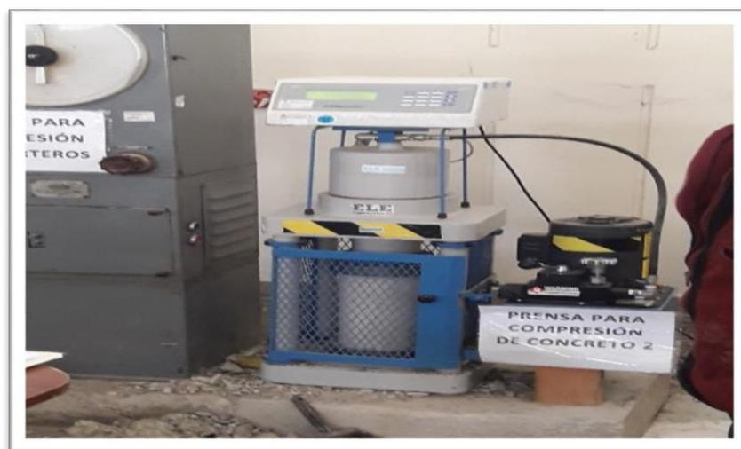
*Figura 15.* Compresora de testigos (probeta)
