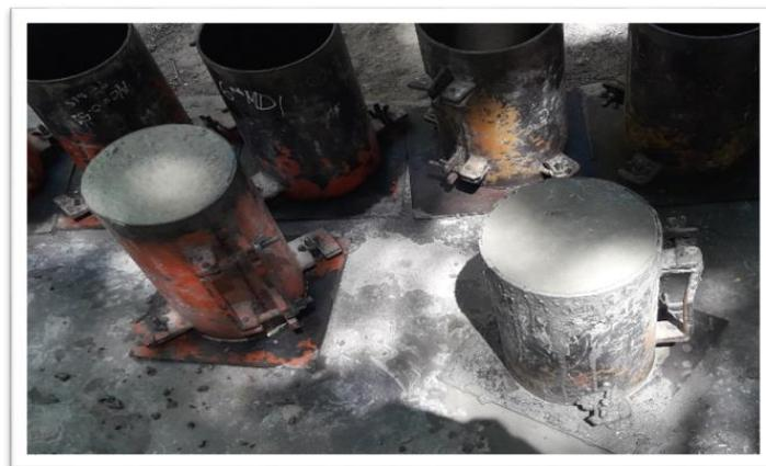
*Figura 12.* Fraguado y posterior endurecimiento de la mezcla
