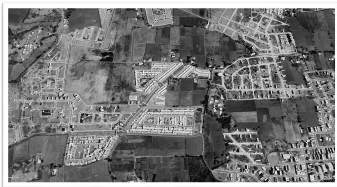
Figura 41: Trazo vial sinuoso, falta de conectividad entre urbanizaciones.
