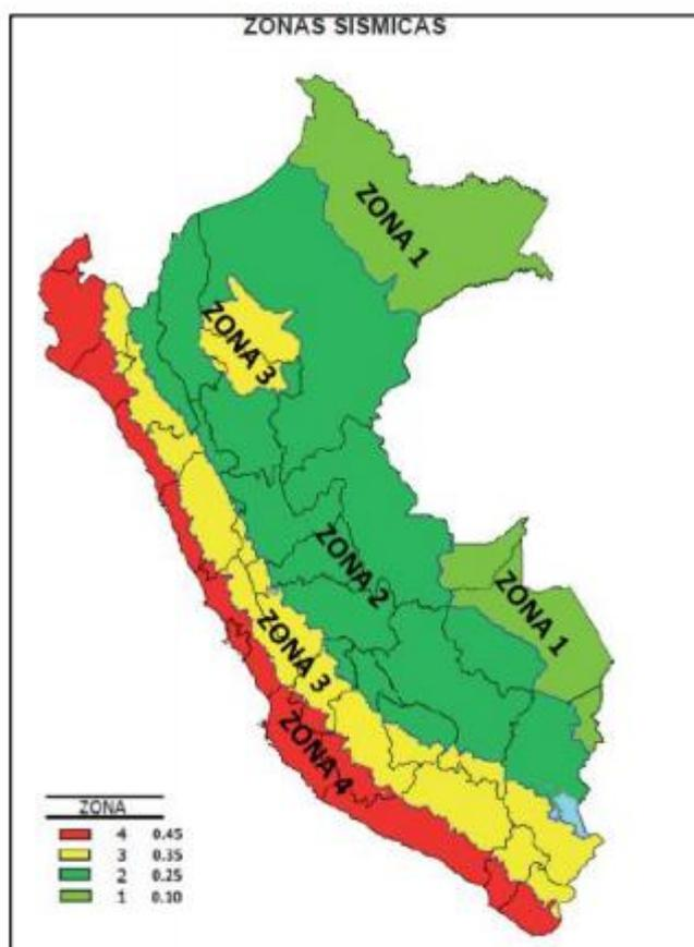
*Nota.* Norma Técnica E.030. Diseño Sismo – Resistente, 2016.
